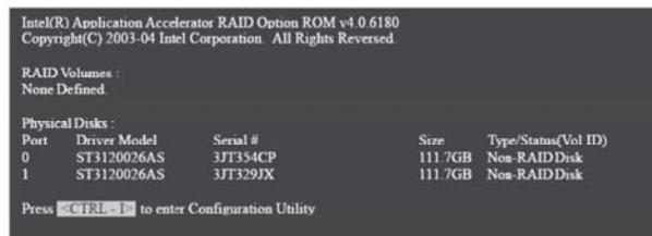
Appuyez sur <Ctrl+I>. La fenêtre Utilitaire RAID Intel – Créer un système RAID apparaît.
