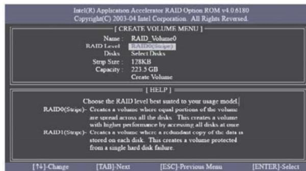
Utilisez les touches de déplacement vers le haut ou vers le bas pour choisir le niveau RAID désiré. Vous pouvez choisir entre le niveau RAID0 (Stripe), le niveau RAID1 (Mirror), le niveau RAID 5, le niveau RAID 10. Appuyez sur <Entrée> puis choisissez la dimension des matrices.
